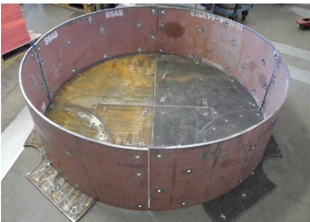
Mischerboden aus HB800A | Seitenwände aus Hardox 500
