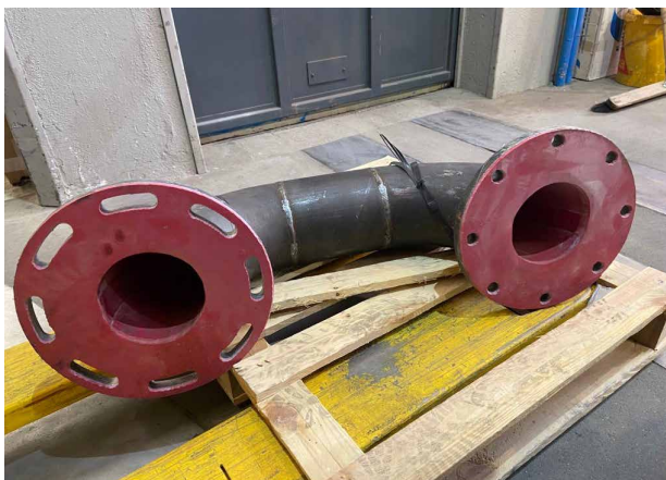
Rohrbogen mit Linatex Gummi gummiert
