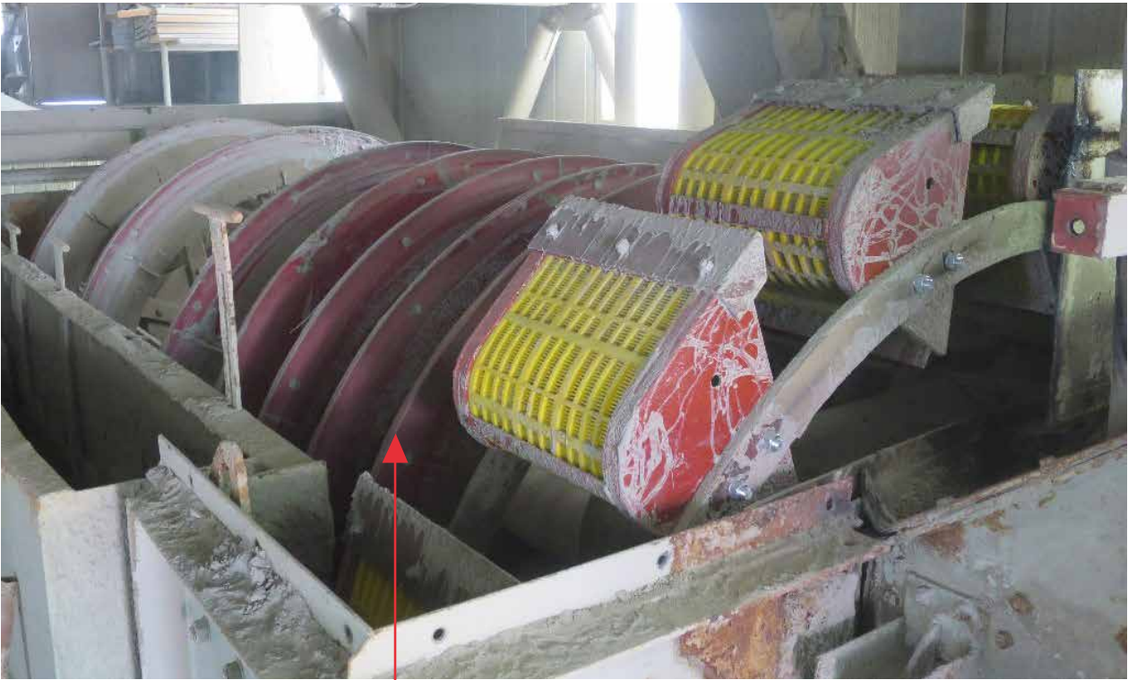
PU Schneckensegmente für Verschleisschutz. Schöpfbecher nach Muster oder Zeichnung.
